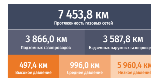
Рис. 1.1.2. Газораспределительная сеть, находящаяся в эксплуатации АО «МОСГАЗ»
